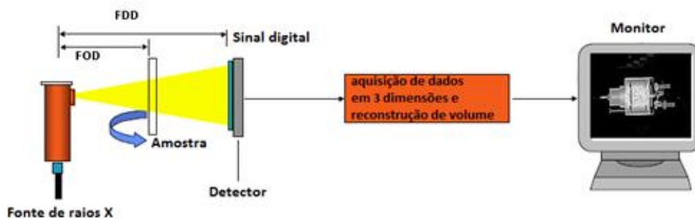
Figura 1: princípios de funcionamento do equipamento de tomografia computadorizada.
